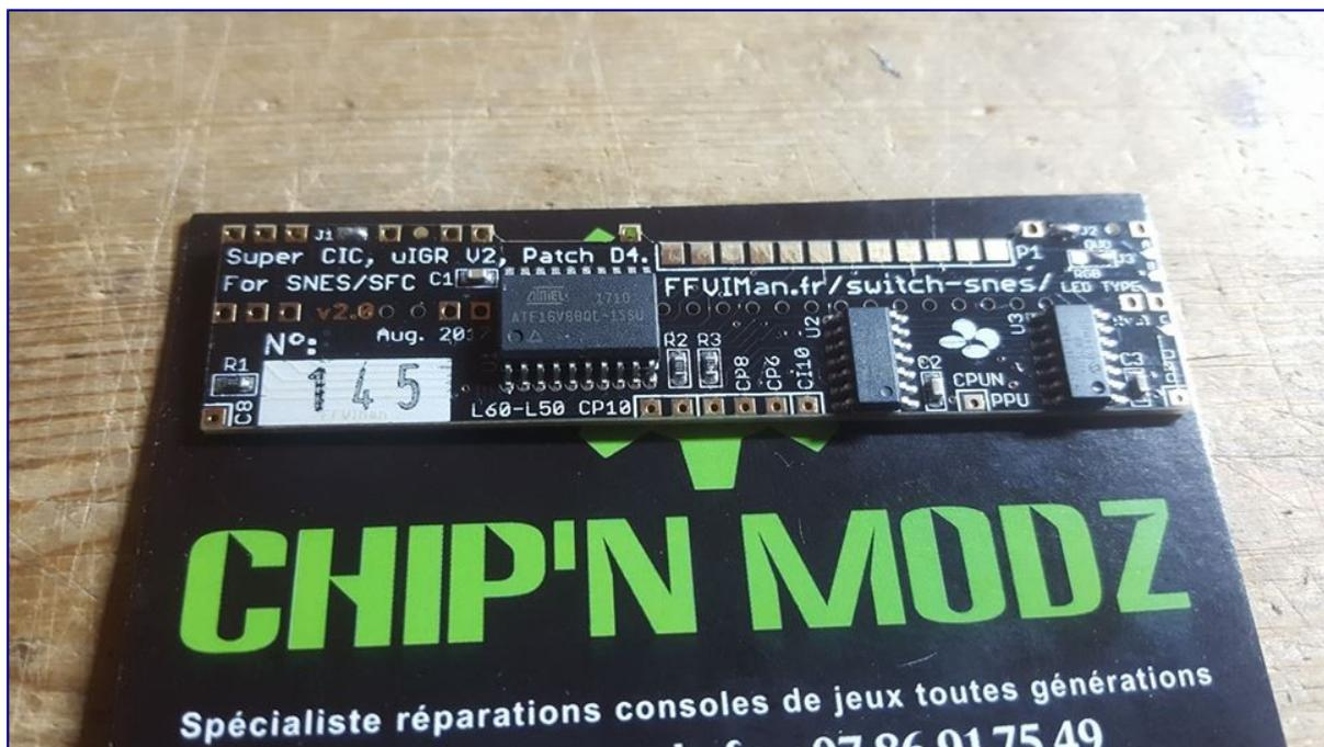
PCB Switchless v2, développé, conçu & assemblé par FFVIMan
