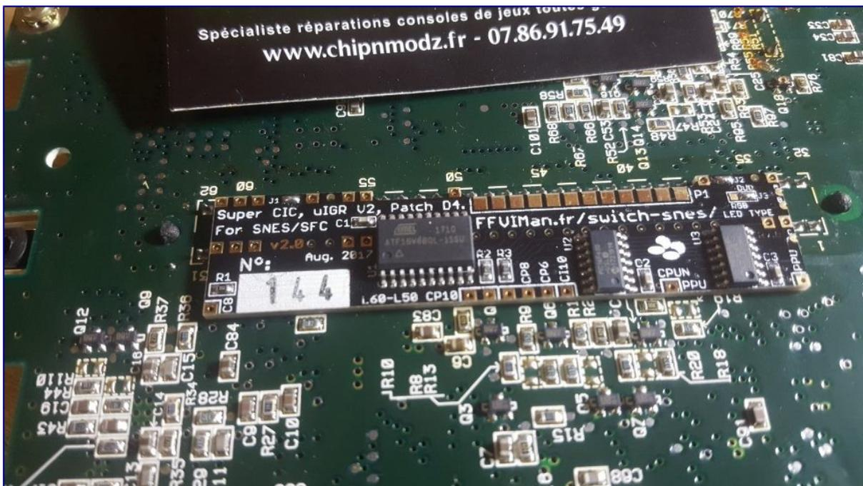
PCB Switchless v2 (FFVIMan), avant soudures !
